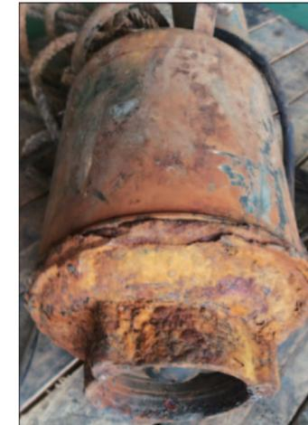
使用一年后泵浦铸件未被侵蚀, 但阳极片已侵蚀完毕, 建议阳极片剩下四分之一时就要更换, 以免失去保护效果。
